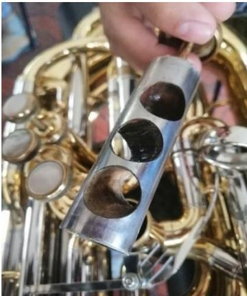
*Nota.* Sistema de guías con suciedad, incrustaciones, y mantenimiento deficiente. Imagen tomada del archivo del autor.
