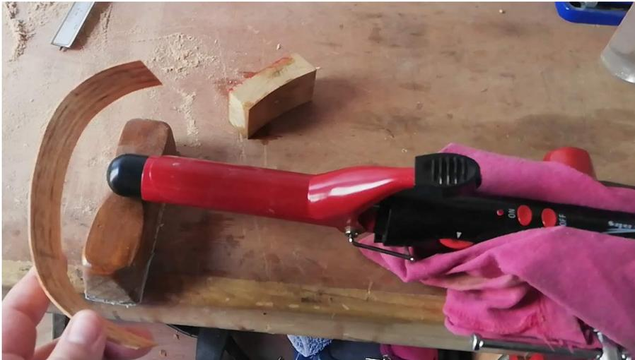
Nota: Esta rizador de pelo mide 15 cm y tiene 10 controles de temperatura. Para poder doblar la madera, usé un taco de madera como apoyo, además de prensar la rizador con una prensa de banco, además de usar un trapo para no partir la rizador ni pelar el material. Tomado de: archivo personal, 2021.
