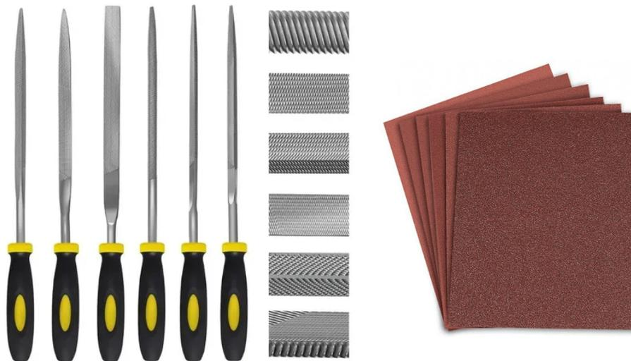
Nota: son herramientas manuales para el desgaste y pulido de materiales como el metal, plástico o madera. Las limas para madera se conocen como escofinas y se diferencian por tener un intervalo mayor entre sus dientes. Tomado de: Bañón y Sánchez, Limas y escofinas <https://xn--baonysanchez-bhb.com/herramientas/limas>
