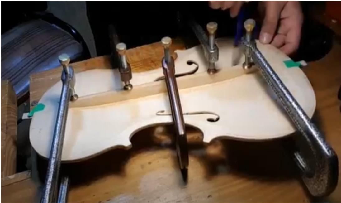
Nota: para el pegado de la barra armónica, se utilizan varias prensas, para que la presión que se ejerza sea uniforme en toda la superficie, hay que tener precaución con las prensas y verificar que tengan algún recubrimiento, ya sea con tela, cuero o corcho. Tomada de: archivo personal, clase virtual curso de construcción de violín María Machado, 2021.
