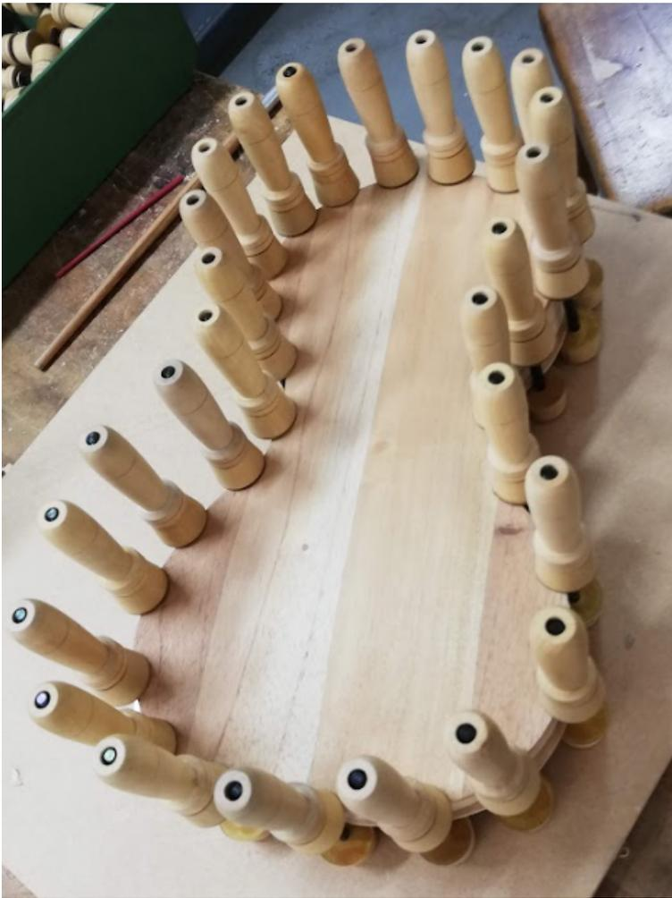
Nota: En la figura se observa el pegado y prensado usando prensas pequeñas de madera que en su interior están recubiertas de tela, para no tallar la madera. Tomado de: archivo personal, 2020.
