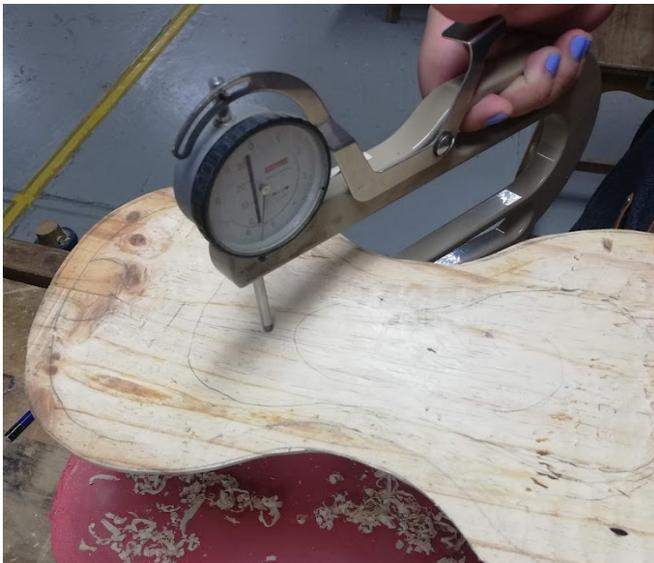
Nota: El calibrador de espesor es una herramienta de gran importancia en la construcción del instrumento, ya que esta da con exactitud el espesor (grosor) de cada curvatura de la tapa armónica y fondo. Tomada de: archivo personal, taller de elaboración de violín y viola, Sena Itagüí, 2021.
