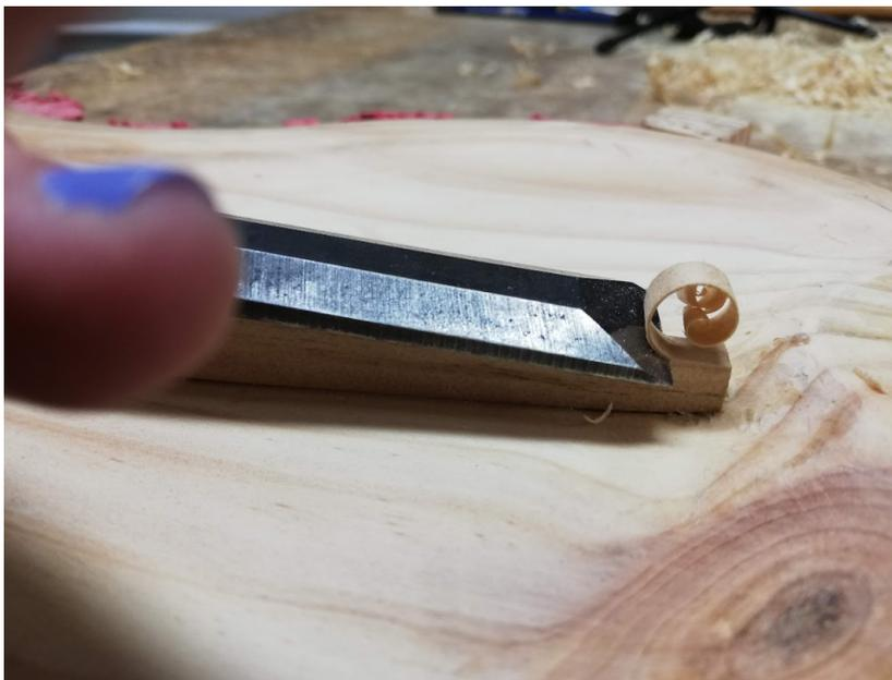
Nota: se puede observar el corte que realiza el formón en la barra armónica, es importante que el formón se utilice (en este caso) con la cara plana hacia la barra armónica. Tomado de: archivo personal, 2021.
