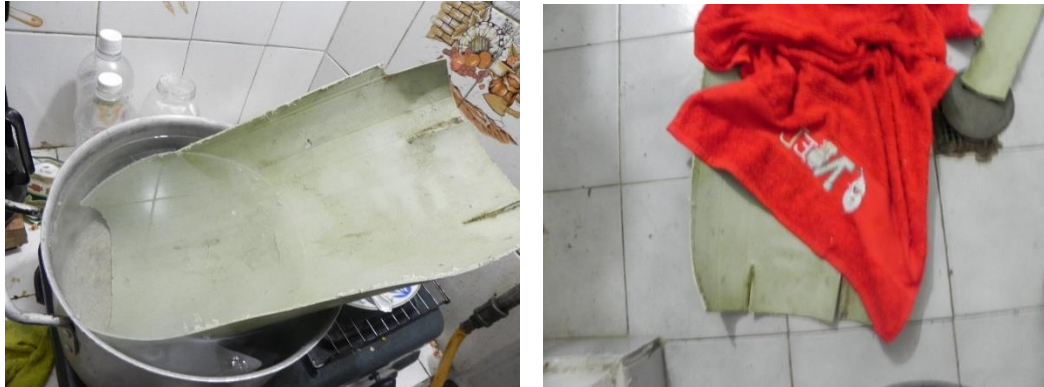
Figura 30. Proceso de corte y calentamiento de tubo de PVC.
