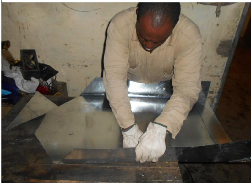
Imagen fabricación de palangana, tomada por el autor, 2018.
