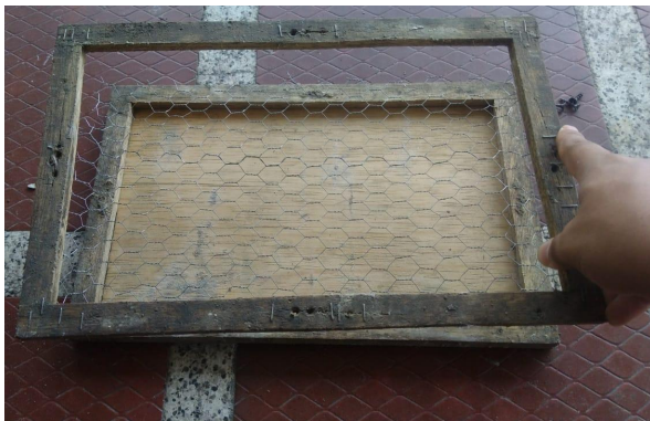
Imagen 27. Fotografía del Enmallado y ajuste de marco en la formaleta. Fuente de elaboración propia.
