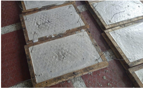
Imagen 30. Fotografía del concreto fundido en las Formaleas. Fuente de elaboración propia.
