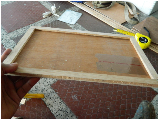
Imagen 24,25. Fotografías de la base de la formaleta montada con su respectivo bastidor y el bastidor superior. Fuente de elaboración propia.
