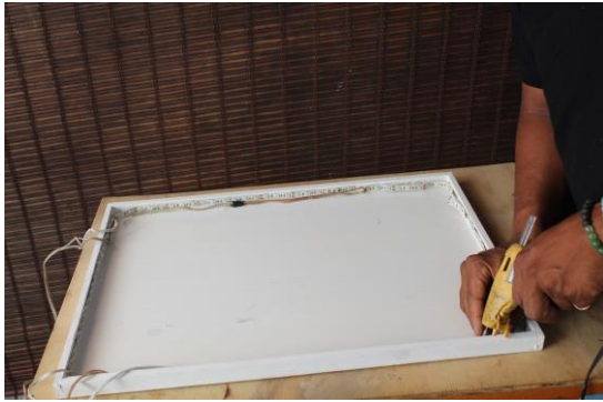
Fotografías de la construcción de la lámpara rectangular de 75 cm x 48 cm e instalación de las cintas led, exploración con arena.
