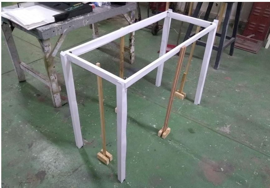
Figura 8. Ensayo de levantamiento de una base de vitrina hecha en papel
